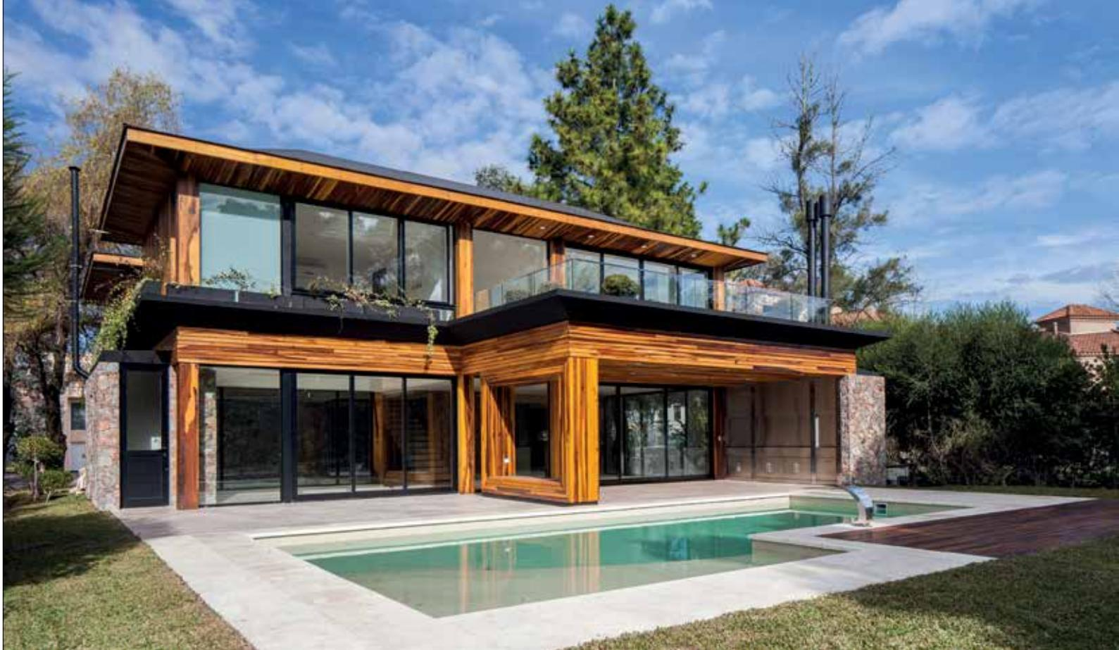
Los elementos estructurales ordenan la planta. Una serie modulada de columnas y losas de hormigón permiten obtener una fachada libre y la desmaterialización de las caras de los volúmenes, que son ocupadas por envolventes de piedra, en planta baja, o por grandes cerramientos de vidrio o pieles de madera en planta alta.
